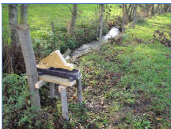
Exemple de pompe de prairie sur zone stabilisée installée dans le cadre du précédent programme sur le syndicat de l'Aron.
